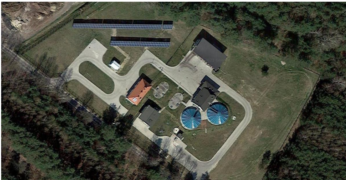
Rysunek 6 Farma fotowoltaiczna do zasilania Oczyszczalni Ścieków w Rzęśni o mocy zainstalowanej 49,92 kW [ https://www.google.ru/maps ]
