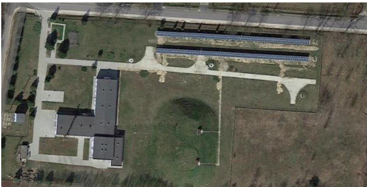
Rysunek 7 Farma fotowoltaiczna do zasilania Hydroforni w Rzęśni o mocy zainstalowanej 99,8 kW [ https://www.google.ru/maps ]
